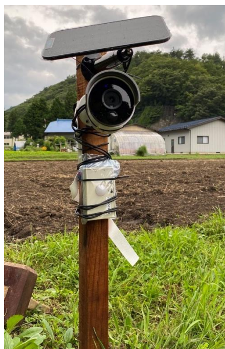
図 2-19 （左）人感センサユニット ES920LRH（Easel 社より）[39]（右）ES920LRH の設置
