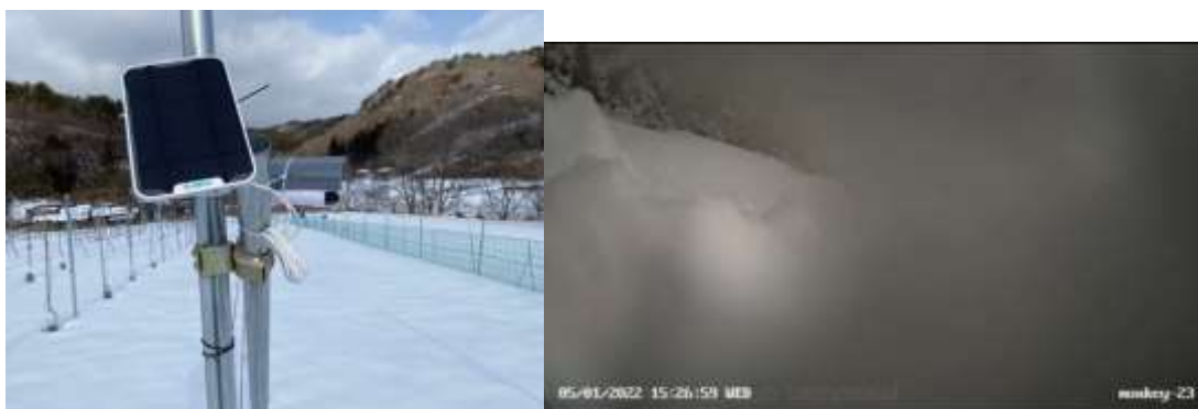
図 14 塩化ビニル管製傘を取り付けた PIR カメラ(左)、 降雨降雪対策なしの PIR カメラ(右):画面の曇りやレンズへの雪付着が生じる
