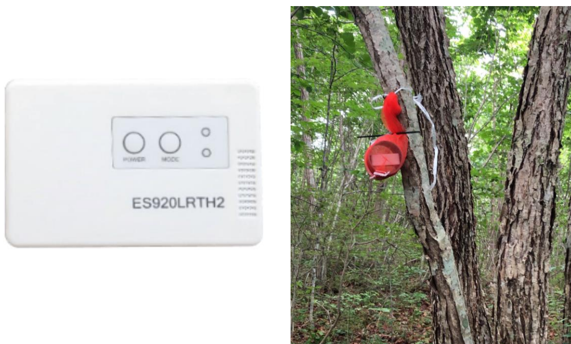
図 2-20 (左) 温湿度センサユニット ES920LRTH2 (Easel 社より) [40] (右) 木の上に設置された様子
