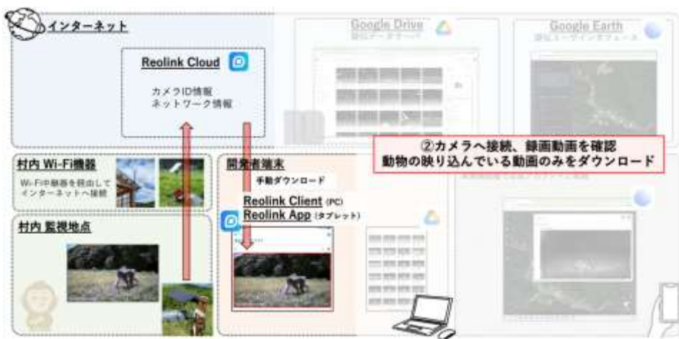
図 17 作成した動画視聴ツールの概説図 2. 撮影動画の遠隔ダウンロード
