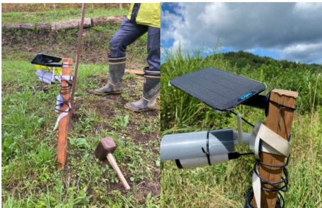
図 11 カメラ設置の様子(左)、木杭をハンマーで打ち込み、ソーラーパネルと PIR カメラを括り付けて設置。カメラ設置後の様子(右)
